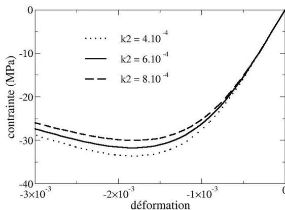
Figure 4.3.2.2-c : Dépendance de la réponse en compression simple vis-à-vis de  $k_2$
