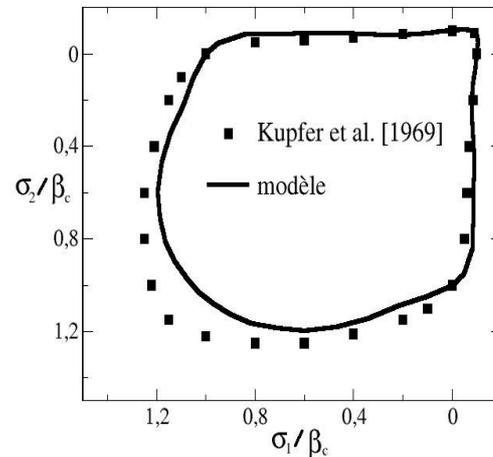
**Figure 6.5.2-b : Prédiction du modèle pour l'enveloppe de rupture d'essais biaxiaux en contraintes planes**
