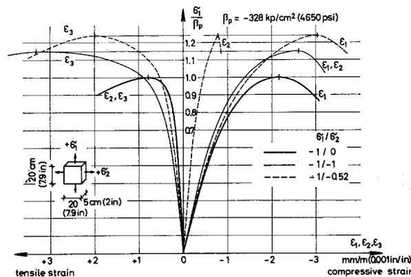
Figure 6.5.1-a : Essai biaxiaux de Kupfer et al. [1969]
