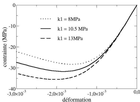
**Figure 4.3.2.1-a : Dépendance de la réponse en compression simple vis-à-vis de  $k_1$**
