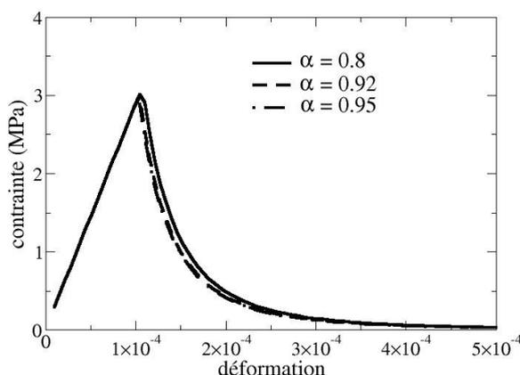
Le paramètre  $\alpha$  a une influence relativement faible sur le pic de contrainte en traction pour la gamme de valeurs considérées comme on peut l'observer sur la [Figure 4.1.1-a]. On reste en effet dans le cas où la force thermodynamique associée à l'endommagement de traction est prépondérante dans le critère (ce ne serait pas le cas si l'on prenait  $\alpha$  proche de 0)
