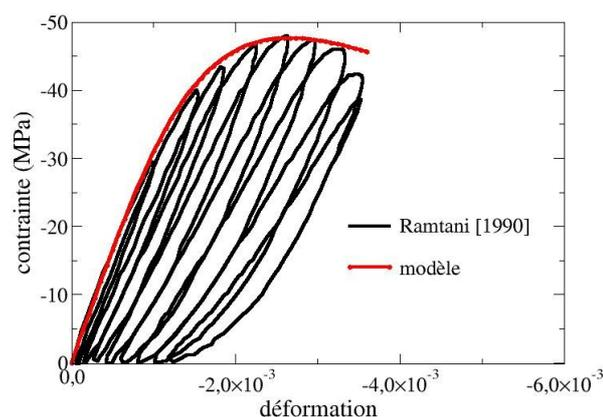
Figure 6.3.2-a : Essais de compression simple de Ramtani [1990]
