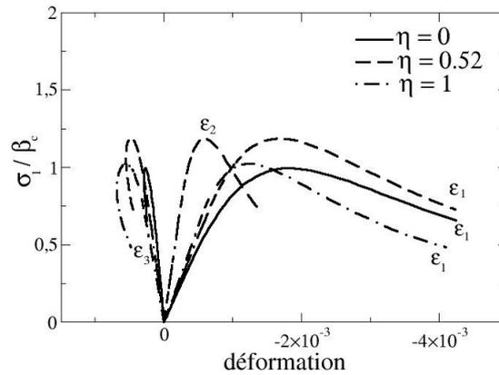
Figure 6.5.1-b : Réponse du modèle pour les essais biaxiaux
