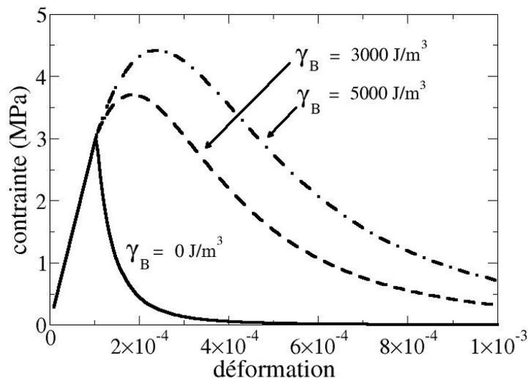
Figure 4.2.1-a : Influence de l'énergie bloquée sur un essai de traction simple
