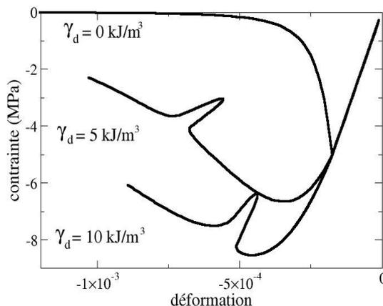
Figure 4.2.2.1-a : Influence de l'énergie bloquée dans un essai de compression simple
