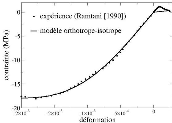
Figure 6.4-b : Essais de traction suivi d'une compression simple (Ramtani [1990])
