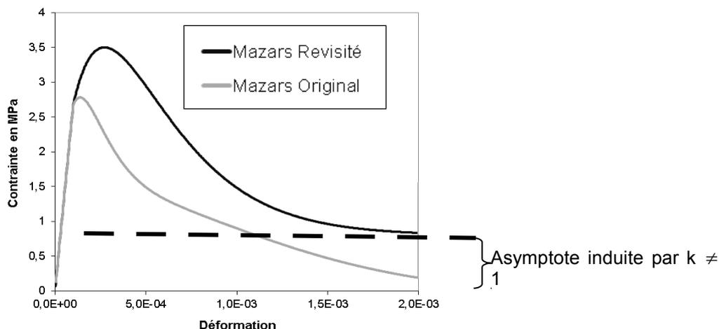
**Figure 2.2-3 : Courbe contrainte-déformation lors d'un essai de cisaillement pur sur un point de Gauss**
