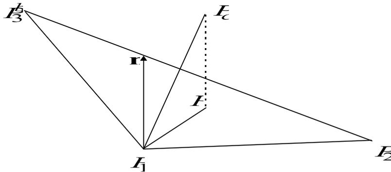
Soit  $P_0^c$  la position initiale d'un point de câble dans la géométrie non déformée et soit  $P^c$  la position de ce même point après déformation. Appelons  $P_0^p$  la projection de  $P_0^c$  sur la surface du feuillet moyen de la coque de béton non déformée et  $P^p$  la projection de  $P^c$  sur la surface du feuillet moyen de la coque de béton déformée. Soit  $\vec{n}_0$  la normale au plan moyen de la coque de béton en  $P_0^p$  et  $\vec{n}$  celle en  $P^p$ .
