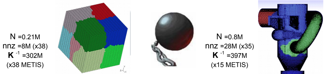
Figure 1.6-1._ Le «boulet» des solveurs directs creux: la taille de la factorisée.
