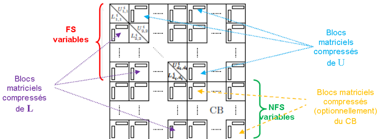
Figure 7.6.1_ Structure d’un front compressé après sa factorisation.
