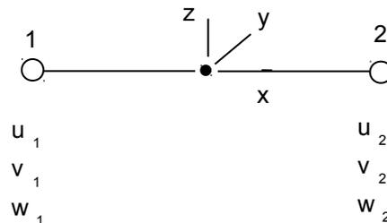
Dans le cas des poutres droites, la ligne moyenne est suivant l'axe  $x$  de la base locale, les déplacement transversaux s'effectuant ainsi dans le plan  $(y, z)$ .
