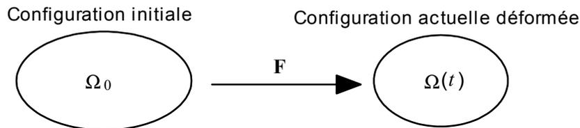
Figure 3.1-a : Représentation de la configuration initiale et déformée
