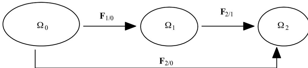
Le passage de la configuration  $\Omega_0$  à  $\Omega_2$  est donné par le tenseur gradient  $\mathbf{F}_{2/0}$  (déplacement  $\mathbf{u}_{2/0} = \mathbf{u}_{2/1} + \mathbf{u}_{1/0}$ ) tel que :
