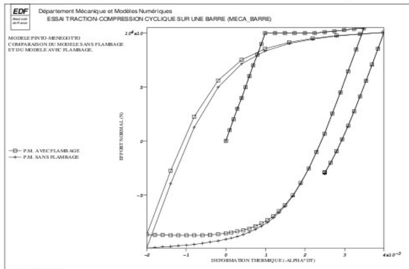
Figure 6.2-b : Comparaison avec et sans flambage.
