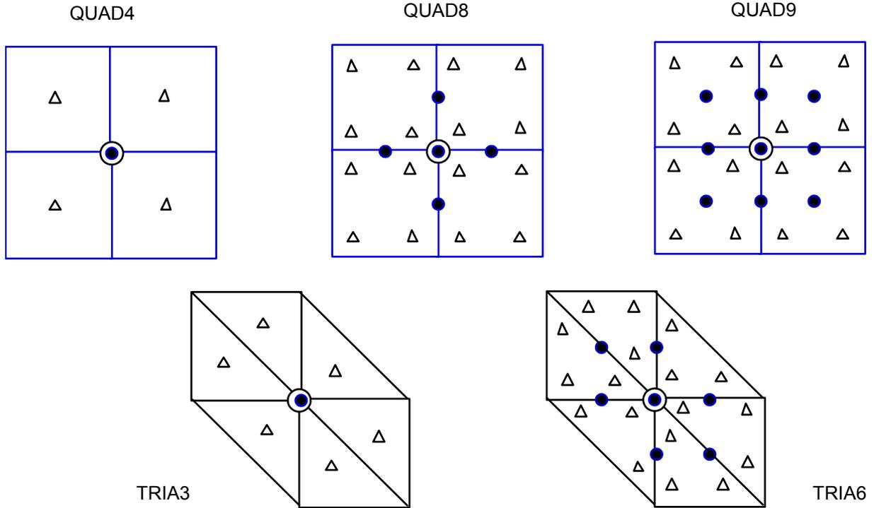
△ points de GAUSS où sont calculées les contraintes  $\sigma_h$  suivant l'équation [éq 2.1-2]
