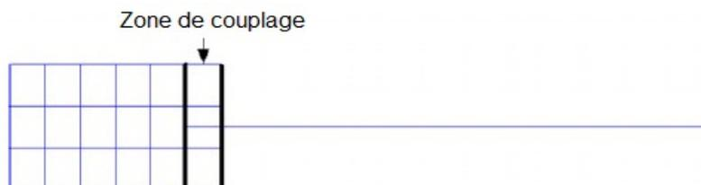
**Figure 2.1-b représentation schématique d'un raccordement d'un modèle mixte 1D-3D de poutre cantilever avec « maillages hiérarchique »**
