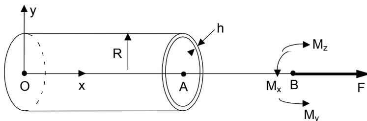
L'encastrement en O est réalisé à l'aide d'une liaison entre le bord de la coque et un élément ponctuel situé en O. Cet élément est encasté (translations et rotations nulles).
