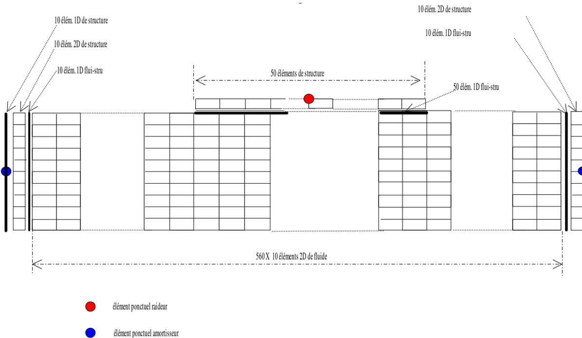
Figure 3.2-a : Maillage bidimensionnel du modèle d'oscillateur fluidélastique
