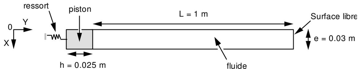
Le système est constitué d'un piston circulaire vibrant au contact d'une colonne de fluide annulaire terminée par une surface libre :
