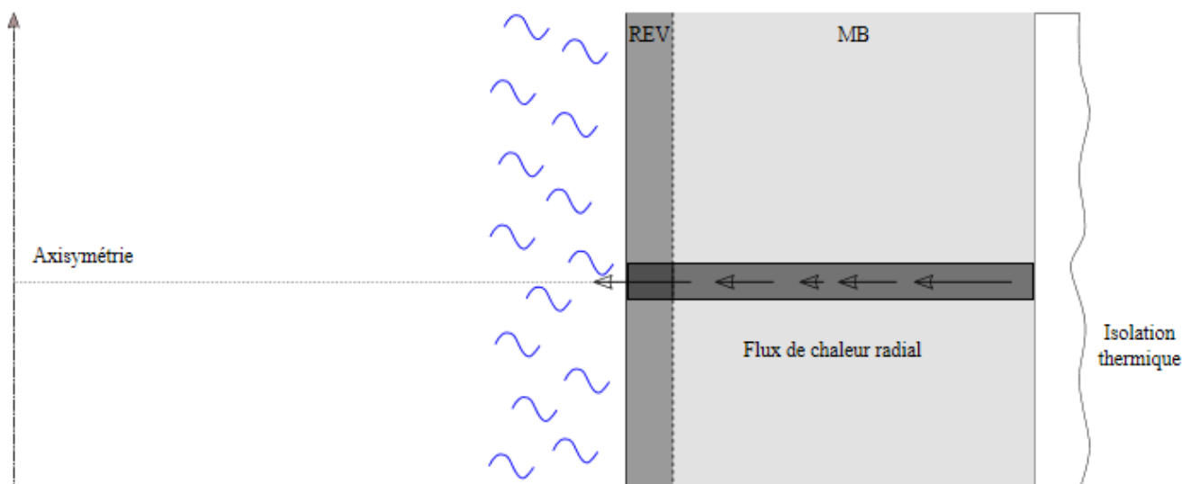
Figure 1.3-a: Problème thermique considéré
