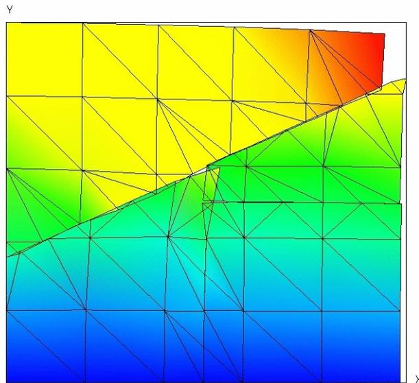
Figure 7.4-a : Déformée de la structure (exagération 10).
