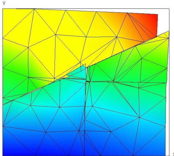
Figure 8.4-a : Déformée de la structure (exagération 10).
