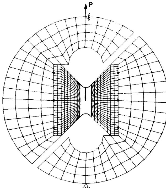
Le porte-éprouvette a un point fixe  $UX = UY = 0$  au trou de fixation inférieur et est soumis à un chargement ponctuel vertical appliqué au trou de fixation supérieur  $UX = 0$ ,  $FY = P$  variable.
