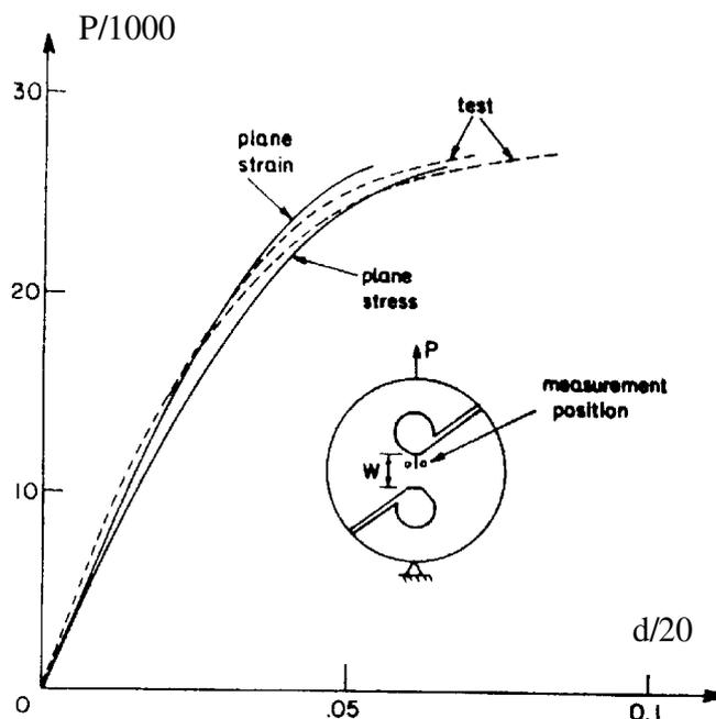
Courbe de réponse donnant la charge  $P/1000$  en fonction du déplacement  $d/20$ . Courbe supérieure calculée en déformations planes, courbe inférieure calculée en contraintes planes. Les courbes en trait interrompu sont des résultats expérimentaux. Contrainte de référence  $\sigma_{ref}=334,6 \text{ MPa}$  (premier point sur la courbe de traction). Épaisseur d'éprouvette  $B=6,36$  ou  $6,39 \text{ mm}$ . Longueur de fissure  $a/W=0,5$ .
