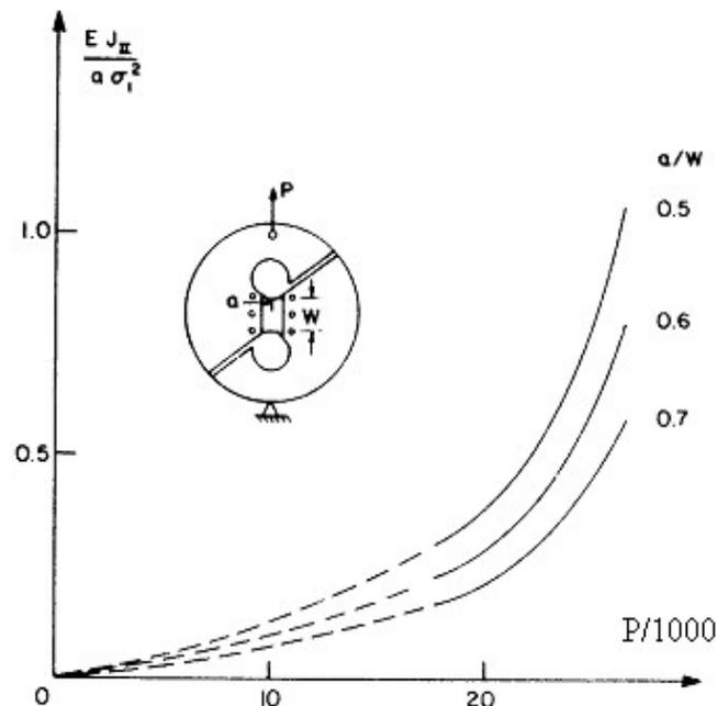
Intégrale normalisée  $E \times J_{II} / (a \times \sigma_{ref}^2)$  en fonction de la contrainte  $P/1000$ , où  $\sigma_{ref} = 334,6 \text{ MPa}$ , pour une éprouvette d'épaisseur  $B = 6,44 \text{ mm}$
