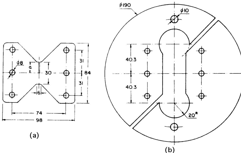
L'éprouvette en forme de diabolo, représentée en (a), est fixée au système de chargement (b) par six goupilles équivalentes à des articulations.
