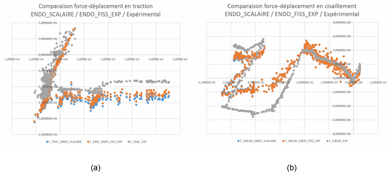
Figure 9 : Courbe force-déplacement expérimentale en traction(a) et en cisaillement (b).
