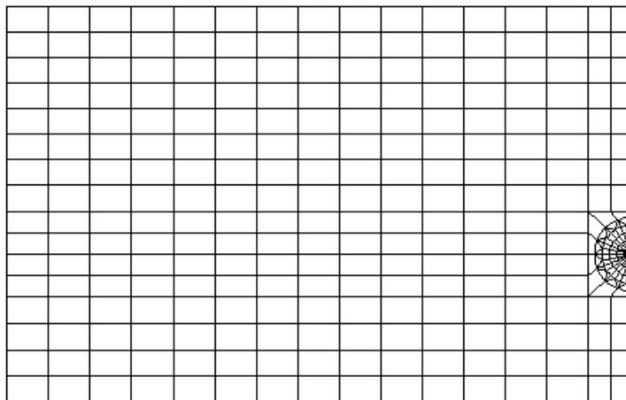
Figure 3.2-a : Maillage de la plaque rectangulaire fissurée
