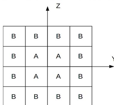
Cette structure a pour avantage de garder les centres de rigidité, de gravité, de torsion confondus à l'origine du repère local de la section et d'être symétrique par rapport à son centre et par rapport aux axes  $Y$  et  $Z$ .
