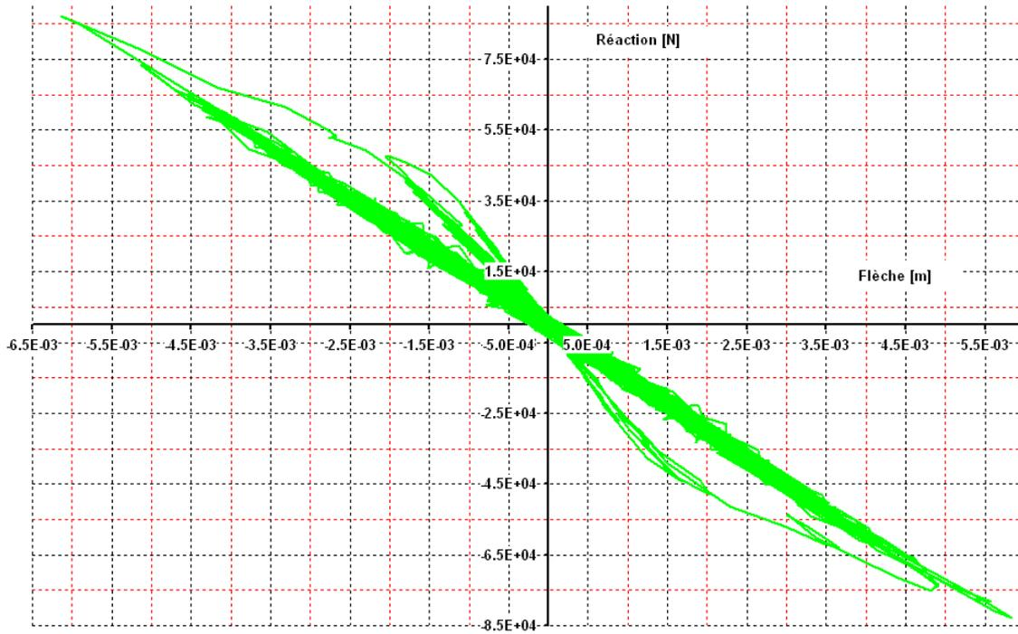
Figure 3.2-f : courbe réaction-flèche, pour 15 secondes.
