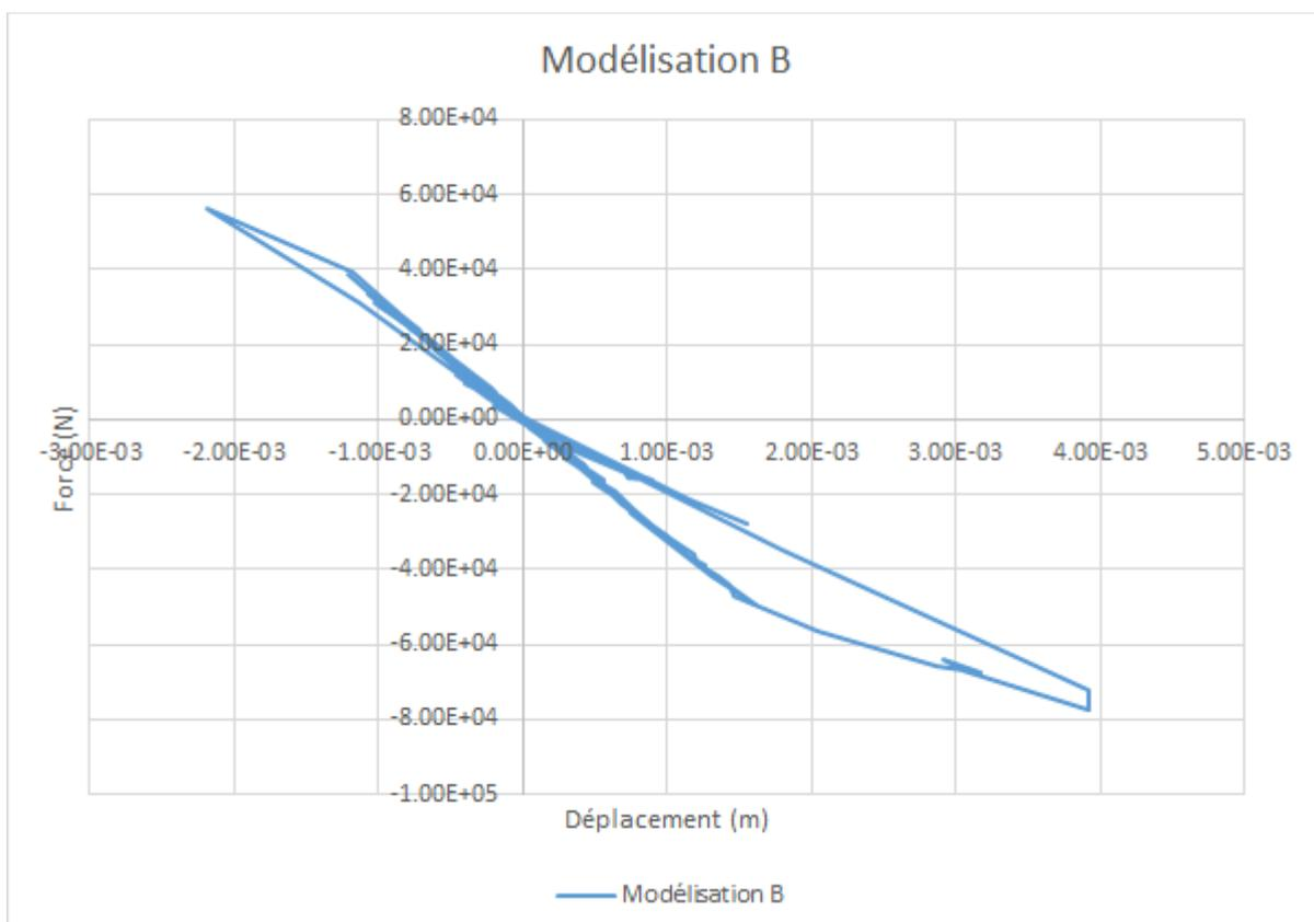
Figure 4.2-c : courbe réaction-flèche pour les trois premières secondes.
