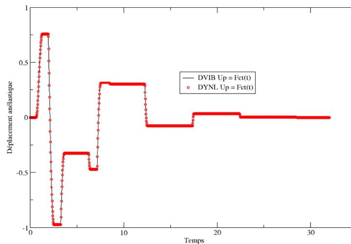
Figure 4.4-d : Comparaison du déplacement anélastique vs temps.
