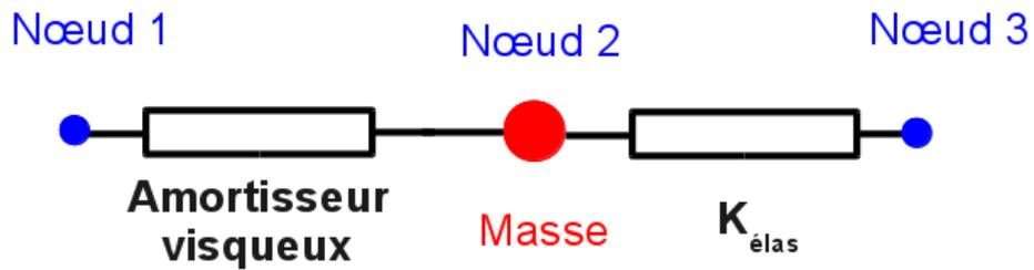
Figure 1.2.2-a : Système modélisé.
