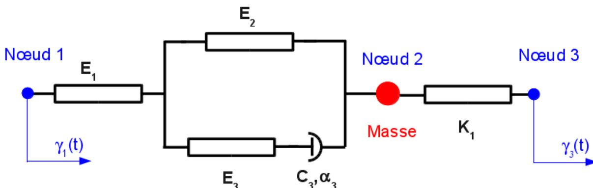
Dans la commande `DYNA_NON_LINE` le schéma en temps est : pour la modélisation B de type `NEWMARK` (accélération moyenne).
