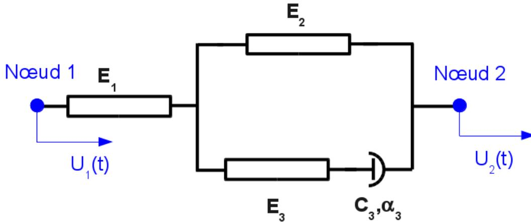
Figure 1.1-a : Modèle rhéologique de l'amortisseur visqueux.
