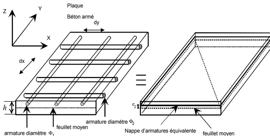
On note  $a_x = \frac{A_x}{d_x}$ ,  $a_y = \frac{A_y}{d_y}$  les taux de ferrailage (ici :  $a_x = a_y = 7,854 \cdot 10^{-4}\text{ m}$ ),  $A_x$  ( $A_y$ ) étant la section d'une barre de fer dans la direction  $x$  ( $y$ ) ;  $e_z$  la distance des nappes à la surface moyenne.
