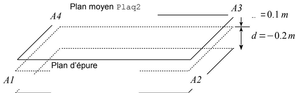
Les éléments utilisés sont des éléments de plaque DSQ.
