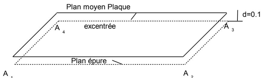
Les éléments utilisés sont des éléments de plaque DKT.
