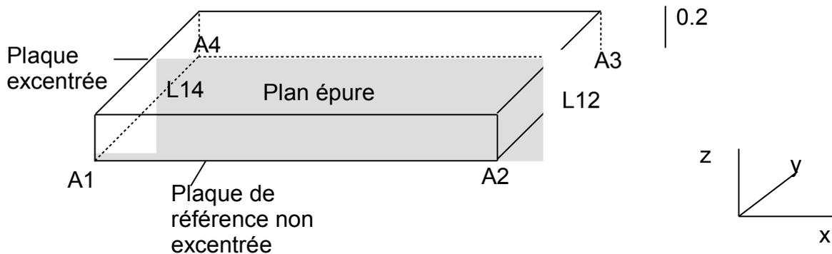
On a représenté ici la plaque excentrée par rapport au plan d'épure (qui est ici confondu avec le plan inférieur de la plaque excentrée).
