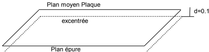
Les éléments utilisés sont des éléments de plaque DSQ.
