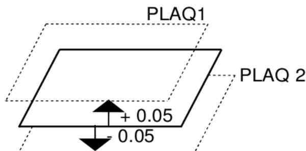
On affecte le comportement 'ELAS\_COQUE' à chacune de ces plaques correspondant au comportement orthotrope homogénéisé de la couche correspondante.
