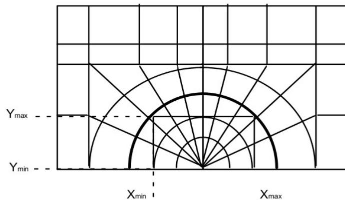
On calcule le champ  $\theta$ , puis le taux de restitution d'énergie  $G$ , les coefficients de contraintes  $K_1$  et  $K_2$ , le taux de restitution d'énergie obtenu par la formule d'IRWIN, la direction de propagation de la fissure.
