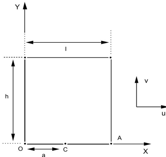
Pour des raisons de symétrie, le modèle est réduit à la demi-structure  $y \geq 0$ .
