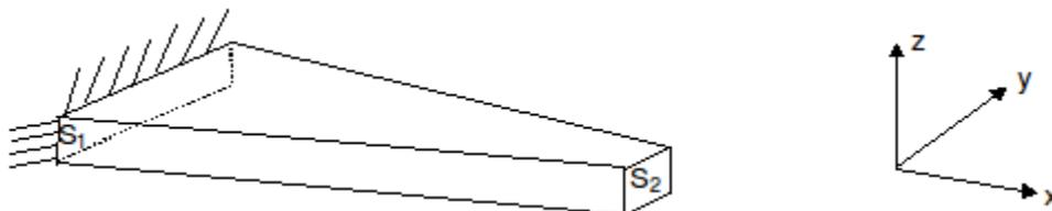
Figure 1.1.3-a : Poutre à section générale variable
