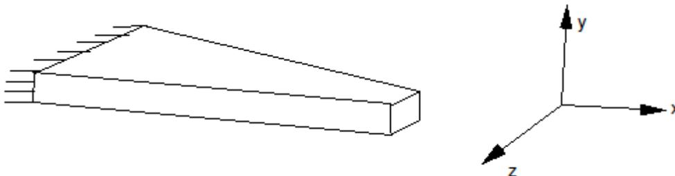
Figure 1.1.2-a : Poutre à section rectangulaire variable
