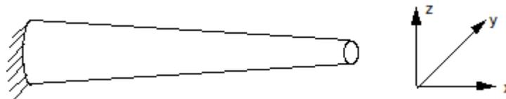
Figure 1.1.1-a : Poutre à section circulaire variable.
