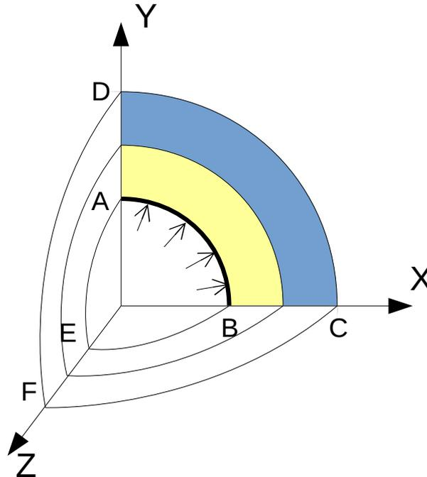
Une pression  $P=25\text{ MPa}$  est imposée sur la surface  $ABE$ , à l'intérieur de la première sphère. Les deux sphères sont maintenues en contact à l'interface.
