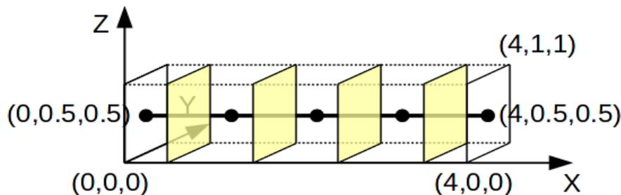
La section multifibre est composée de 4 fibres dont les coordonnées par rapport à l'axe de la poutre sont les suivantes :
