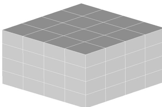
Le maillage `D_PLAN` contient 16 éléments de type `QUAD4` de dimension  $1 \times 1 \text{ mm}$  :
