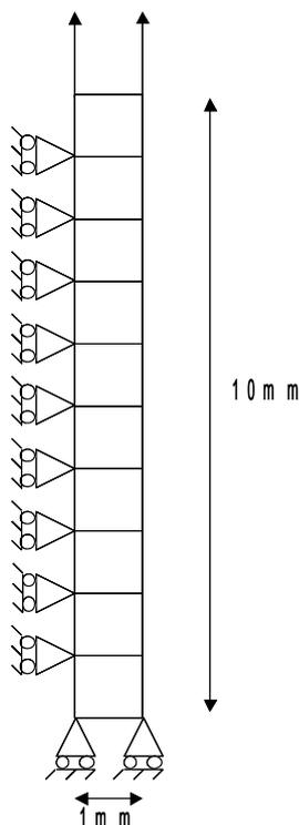
Figure 1.1 : Barreau axisymétrique.
