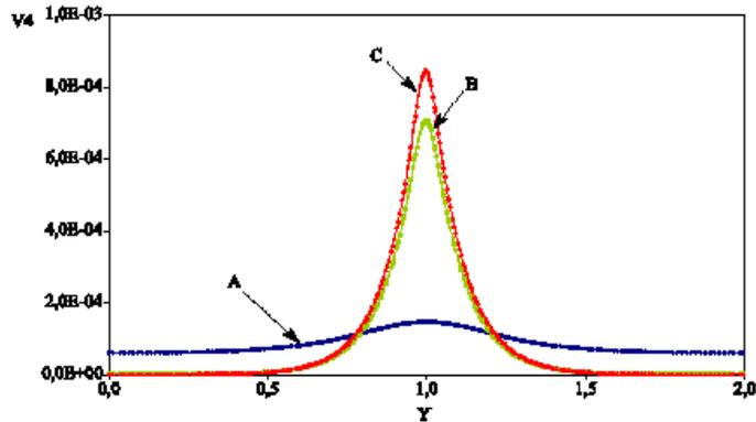
Figure 5.1-4: Déformation équivalente sur l'axe longitudinal de l'éprouvette (loi MAZARS).
