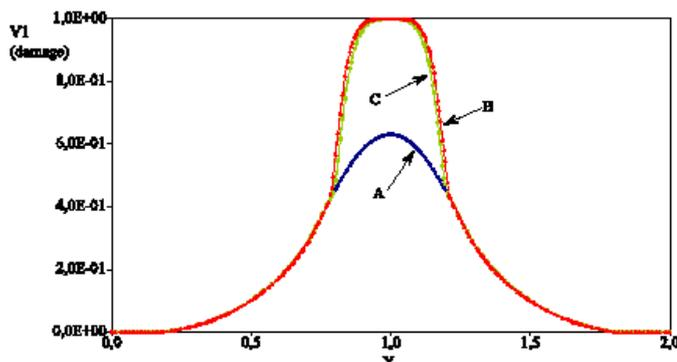
Figure 5.1-3: Endommagement sur l'axe longitudinal de l'éprouvette (loi MAZARS).
