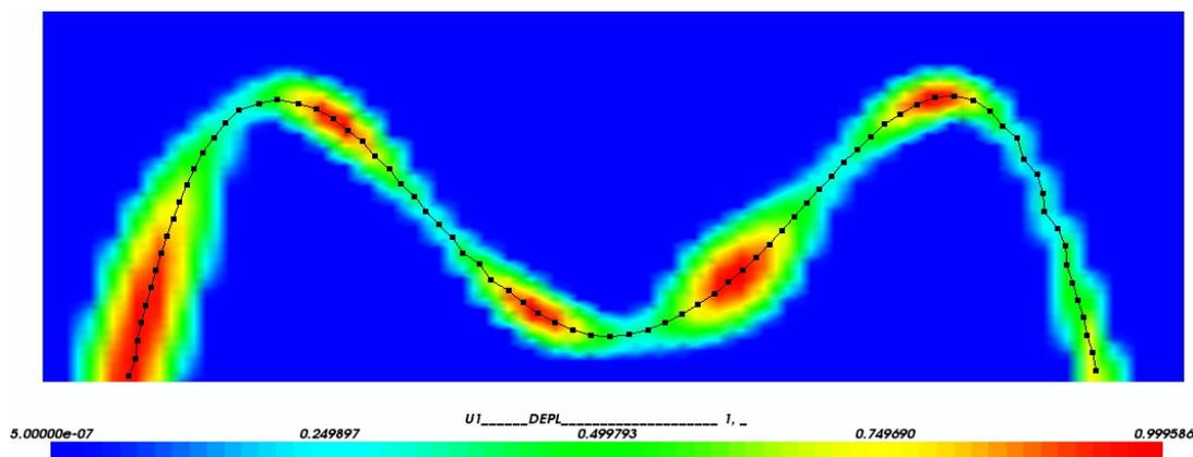
Figure 2.1-2: trajet de fissuration superposé au champ post-traité.
