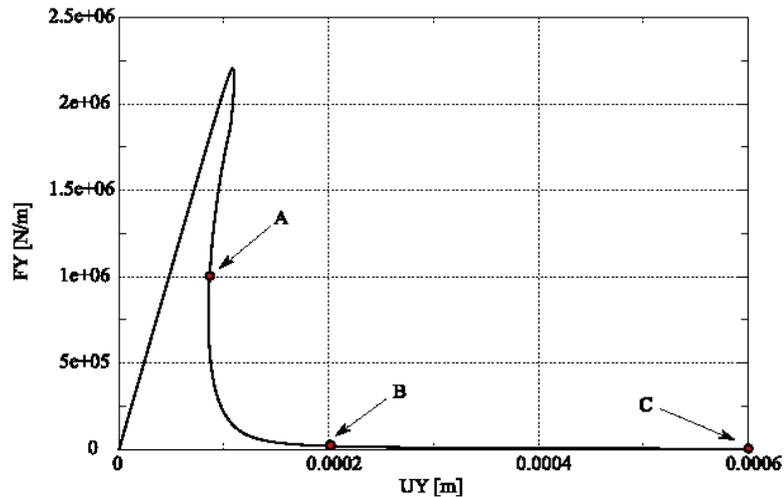
Figure 4.1-1: Courbe force-déplacement, éprouvette bi-entallée (loi `ENDO_SCALAIRE`).
