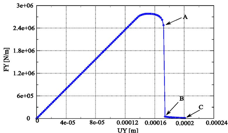
Figure 5.1-1: Courbe force-déplacement, éprouvette bi-entallée (loi MAZARS).
