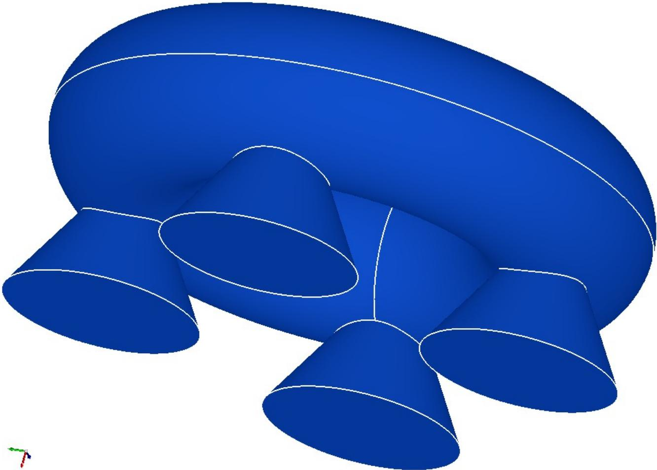
La structure est un tore centré sur l'origine et d'axe Ox. Son rayon de révolution est de 400 et le rayon du disque qui tourne autour de l'axe est de 160. Les pieds sont des cônes d'axe Ox et d'angle 30 degrés.
