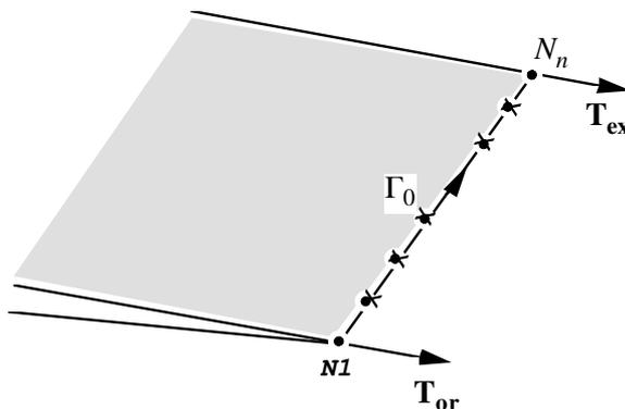
Exemple 1 : cas d'une fissure plane rectiligne :
