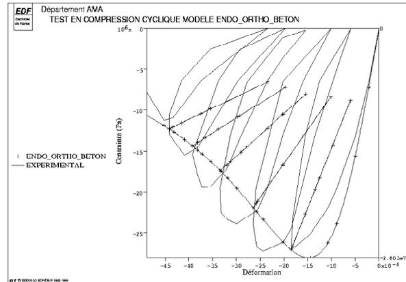
Figure 4.4.2-b : relation  $(\sigma - \epsilon)$  en compression cyclique ENDO\_ORTH\_BETON.
