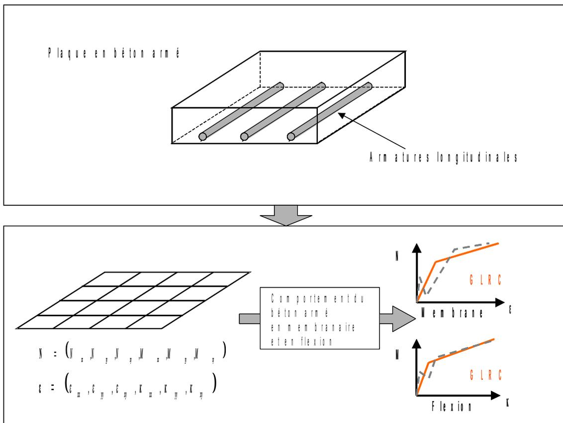
Figure 3.5.2-a : modèle de plaque globale en béton armé.
