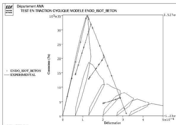
Figure 4.4.1-a : relation  $(\sigma - \epsilon)$  en traction cyclique ENDO\_ISOT\_BETON .
