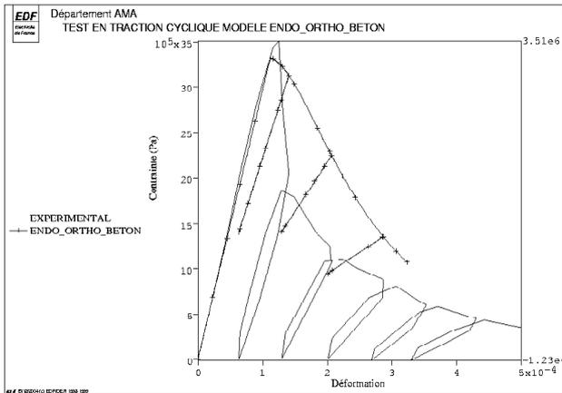
Figure 4.4.2-a : relation  $(\sigma - \epsilon)$  en traction cyclique ENDO\_ORTH\_BETON.
