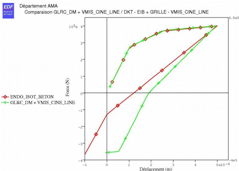
Figure 4.4.5-a : réponse élémentaire – test en traction-compression.
