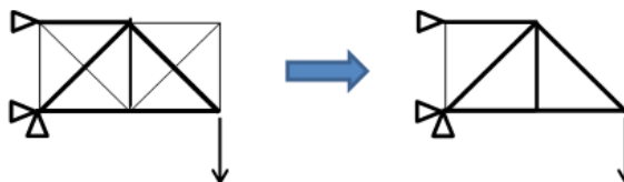
Figure 3.5-b : Optimisation topologique. Elimination d'éléments
