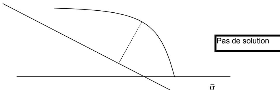
Or, la solution doit respecter la condition  $s_{II} > 0$ , c'est-à-dire  $F(\bar{\sigma}, \gamma) = (\bar{\sigma}_3 - \bar{\sigma}_1) - \sqrt{-\bar{\sigma}_3 \cdot m \sigma_c + S \sigma_c^2} - b \cdot \left(1 - \frac{\bar{\sigma}_3}{\sigma_3^{b-d}}\right)$  : on voit donc qu'il existe une zone dans laquelle le problème n'admet pas de solution, qui correspond à  $\frac{\partial F}{\partial \bar{\sigma}_i} = \delta_{i3}$ .
