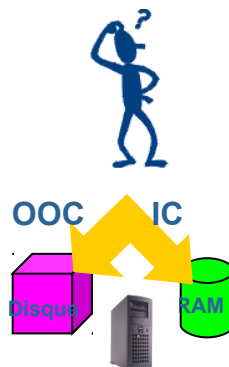
Figure 2.3-3. Deux types de gestion mémoire standards: entièrement en RAM ('IN_CORE') et RAM/disque ('OUT_OF_CORE').
