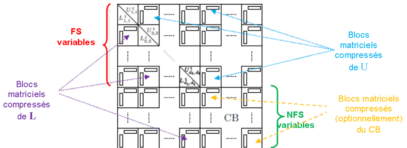
Figure 7.6.1_ Structure d'un front compressé après sa factorisation.
