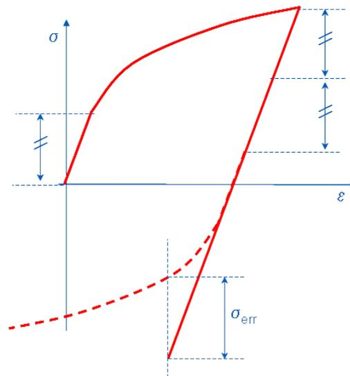
**Figure 2-2 : Écart entre comportement isotrope et comportement réel**
