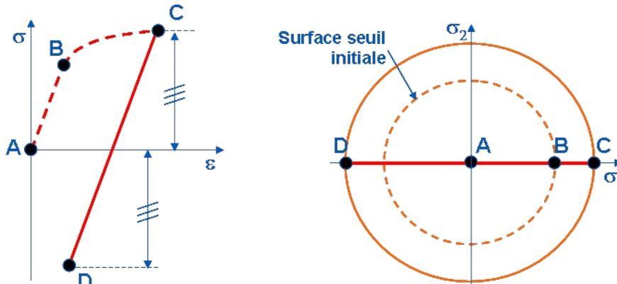
Figure 1.8-1 : Écroissage isotrope
