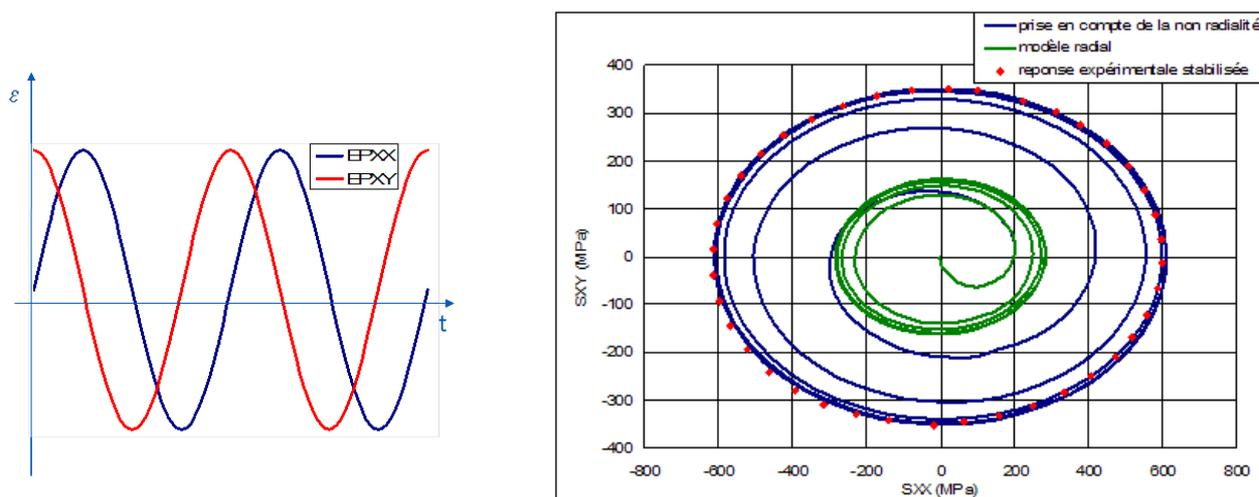
Figure 1.7-1 : Effet de sur-érouissage sous chargement multiaxial non radial
