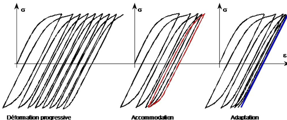
Figure 1.4-1 : Stabilisation de la réponse cyclique du matériau
