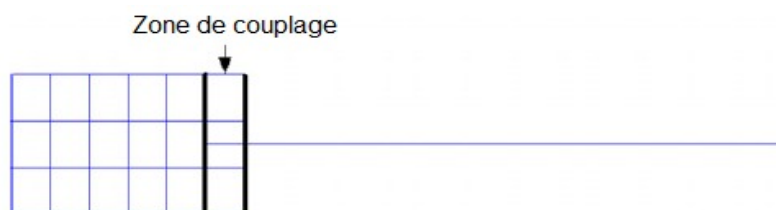
Figure 2.1-b représentation schématique d'un raccordement d'un modèle mixte 1D-3D de poutre cantilever avec « maillages hiérarchique »
