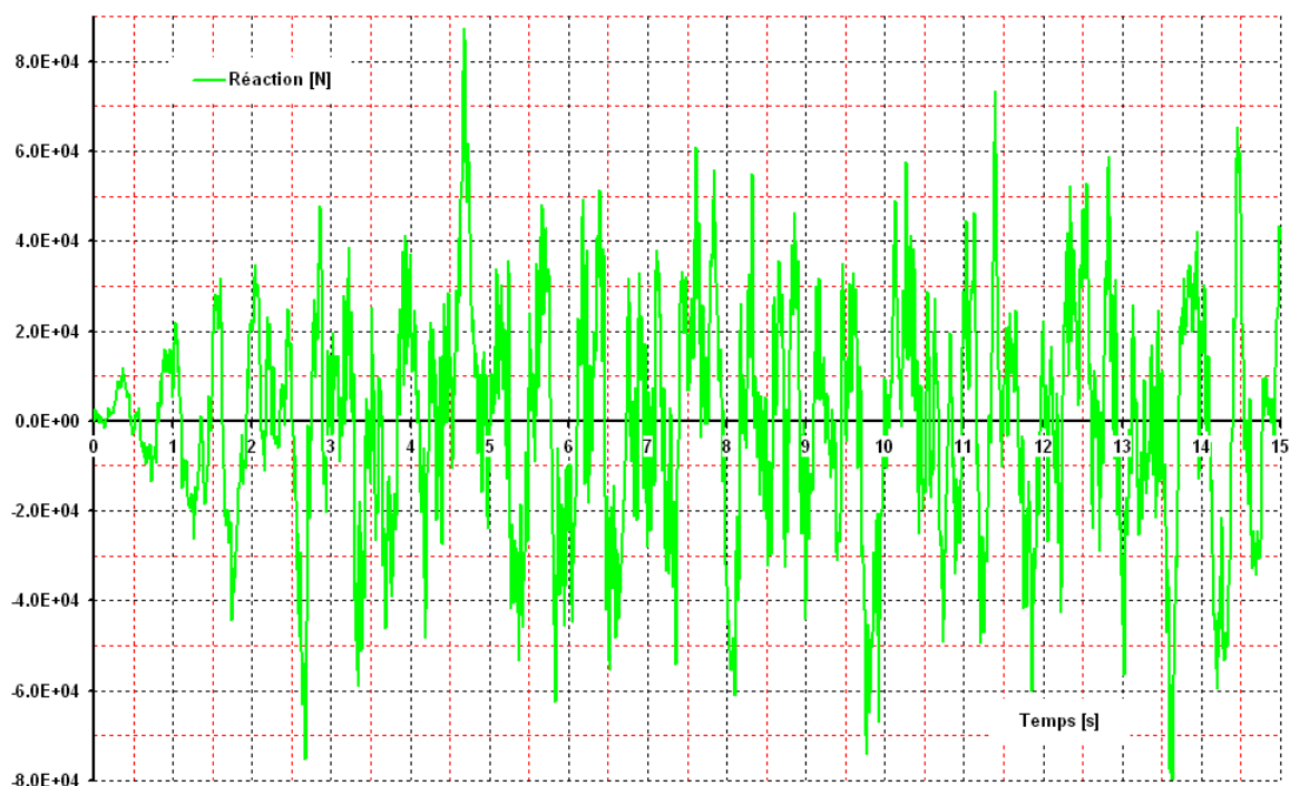
Figure 3.2-d : réaction d'appui en A en fonction du temps, pour 15 secondes.
