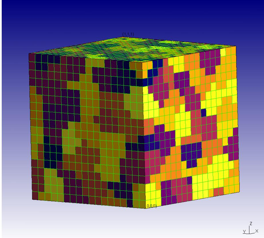
L'agrégat est représenté par un maillage réglé de type hexaédrique occupant un volume de côté 1.
