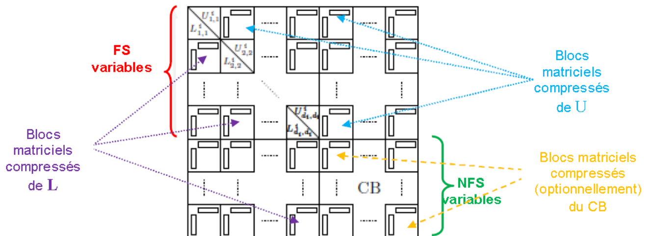
Figure 7.6.1_ Structure d'un front compressé après sa factorisation.
