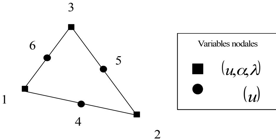
On utilise les familles de points de Gauss des éléments linéaires correspondants, ce qui se traduit par une sous-intégration sur les déplacements. L'utilisation des familles de points de Gauss des éléments quadratiques impliquerait une sur-intégration pour  $\alpha$  et  $\lambda$ , provoquant des oscillations intempestives.
