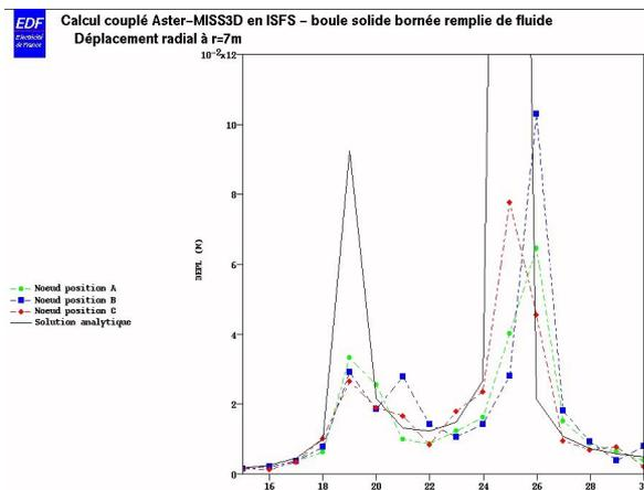
**Figure 4b: déplacements analytiques et calculés du test de la sphère de dimension finie (fréq > 15Hz)**
