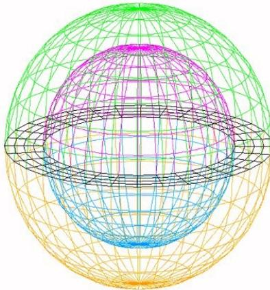
Figure 1.1-b : Modèles et maillages surfaciques des interfaces
