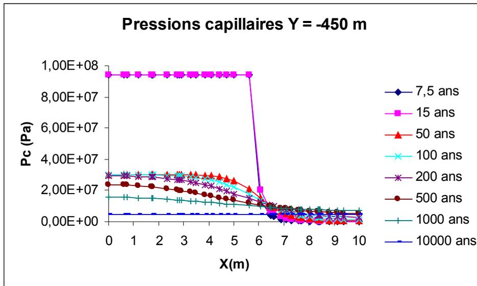
Figure 3.3-a : Profils de pression capillaire  $Y = -450m$
