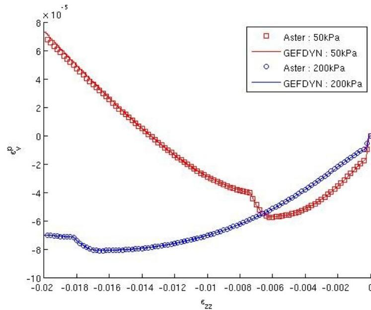
Figure 5-b : Déformation volumique plastique en fonction des déformations verticales pour les deux niveaux de compression à 50 kPa et 200 kPa : comparaison entre les solutions Code\_Aster et Lawyer .
