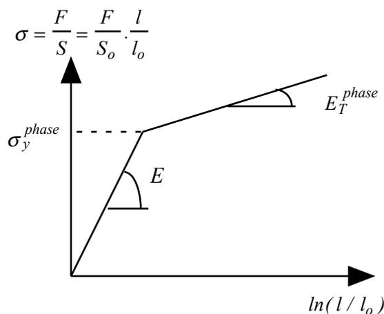
$l_0$  et  $l$  sont, respectivement, la longueur initiale et la longueur actuelle de la partie utile de l'éprouvette.
