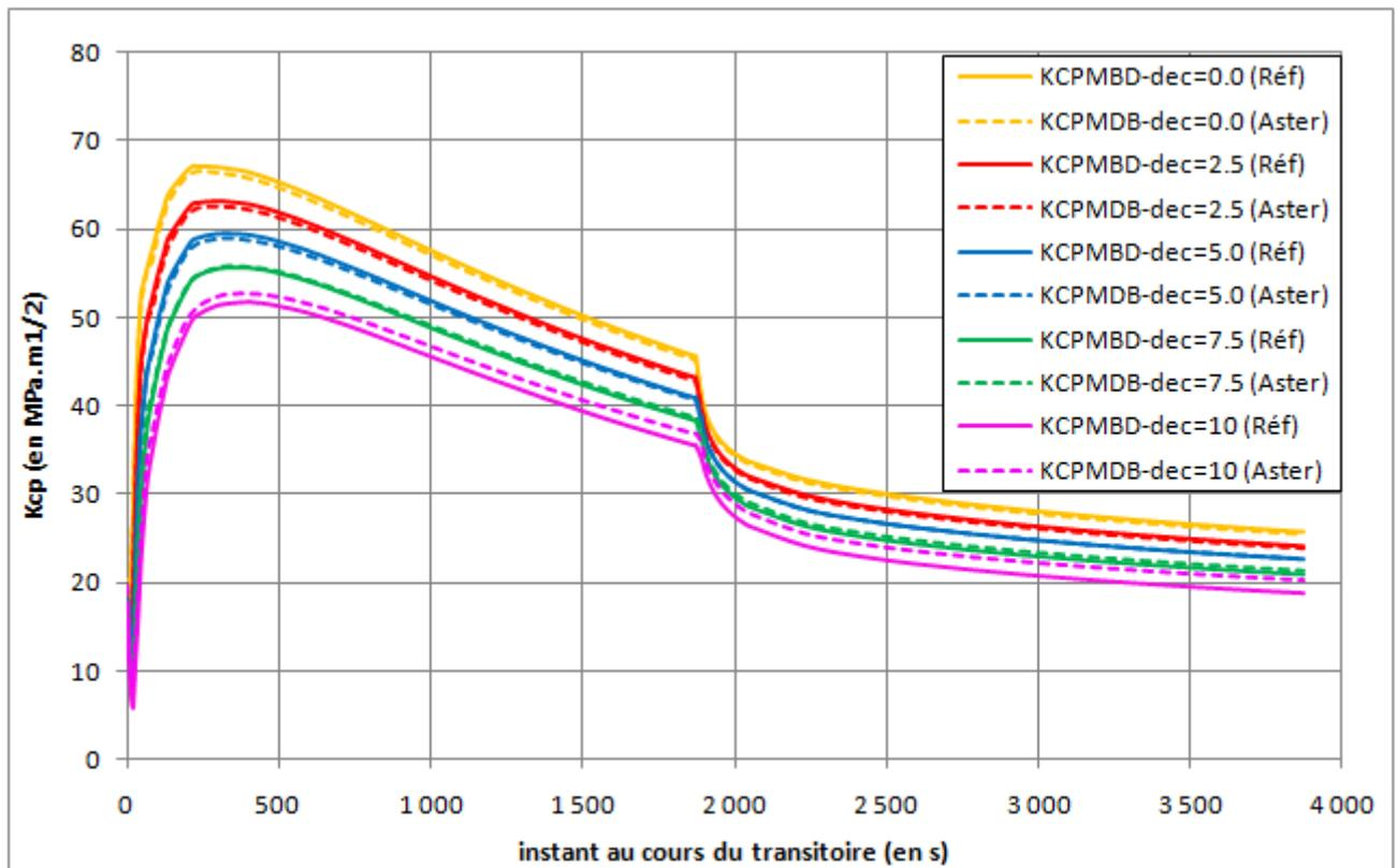
Figure 3.3-d: Facteur d'intensité des contraintes élasto-plastique pour la pointe côté métal de base
