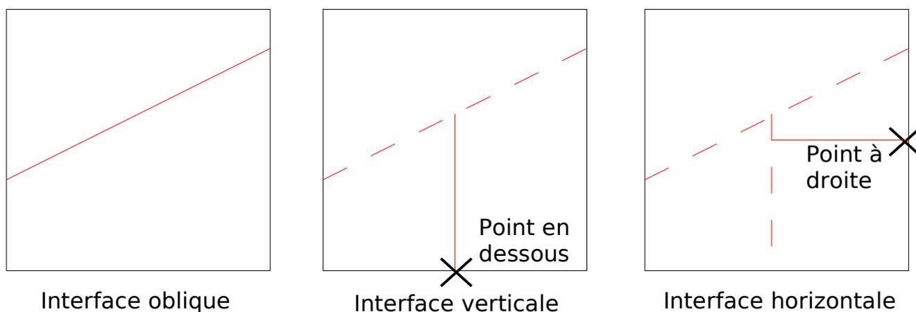
Figure 3.1-a : Étapes de construction de l'intersection.
